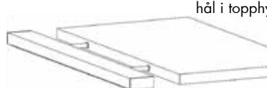
Monteras på framkanten i förborrade
