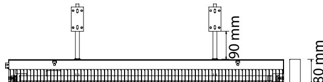
För två konsoler inkl. lysrör och tvär-lamellraster. Armaturhus i aluminium.
